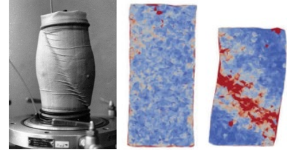
Fig.1 : Une bande de cisaillement observée dans un essai de compression triaxiale classique (à gauche) ; champ de déformation déviatorique à différents stades de déformation axiale : \epsilon_a = 3\% (au milieu) et \epsilon_a = 12\% (à droite).
